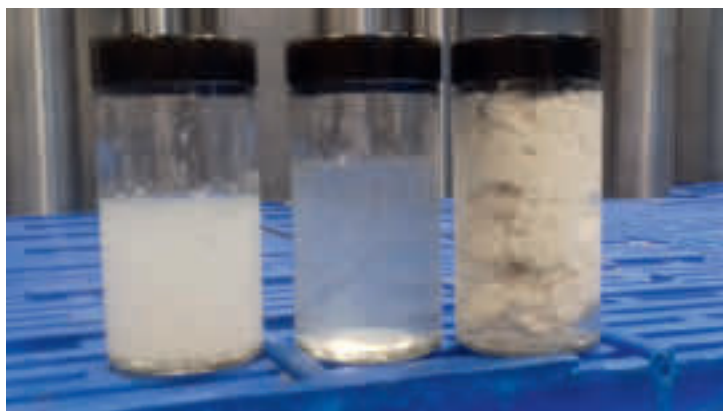
Rys 2. Ścieki z zakładu przetwórstwa mleka w Holandii. Od lewej: ścieki surowe, ścieku oczyszczony, osad flotacyjny.
